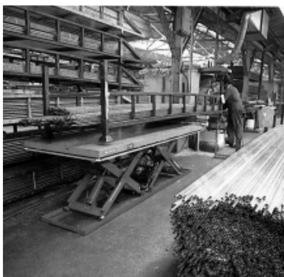
Exempel på applikationer med lyftbord typ DXT i s.k. tandemmontage.
