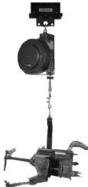
Upphängning av punktsvets i balansblock typ LA
