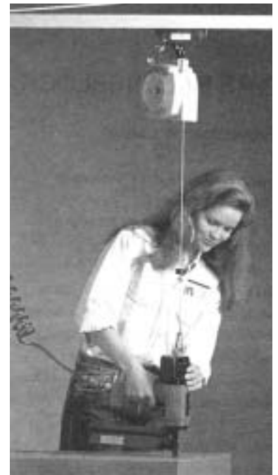
Upphängning av häftpistol i balansblock typ BF
