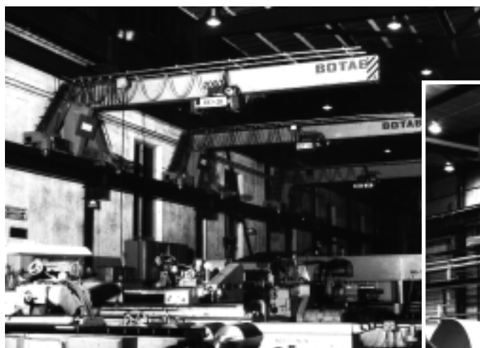
Konsolkranar för 2 tons last vid 7 m utliggning.
