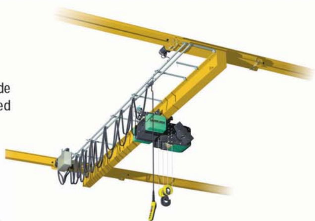
RT-1. Rålgående enbalkstravers med lintelfer. Strömförsörjning till telfer via strömbana.
